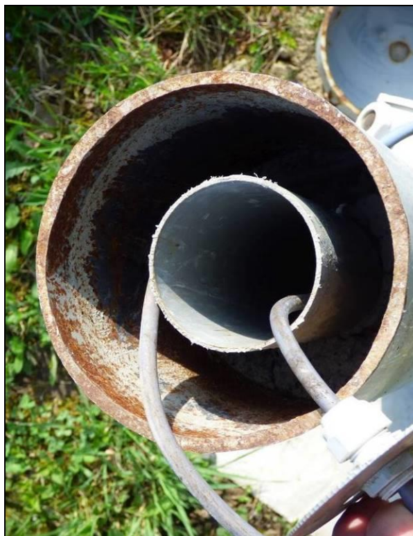
Obr. 8, 9 - Obdobný pozorovací vrt s ponořeným snímačem - sledování hladiny podzemní vody na VD Koryčany.
