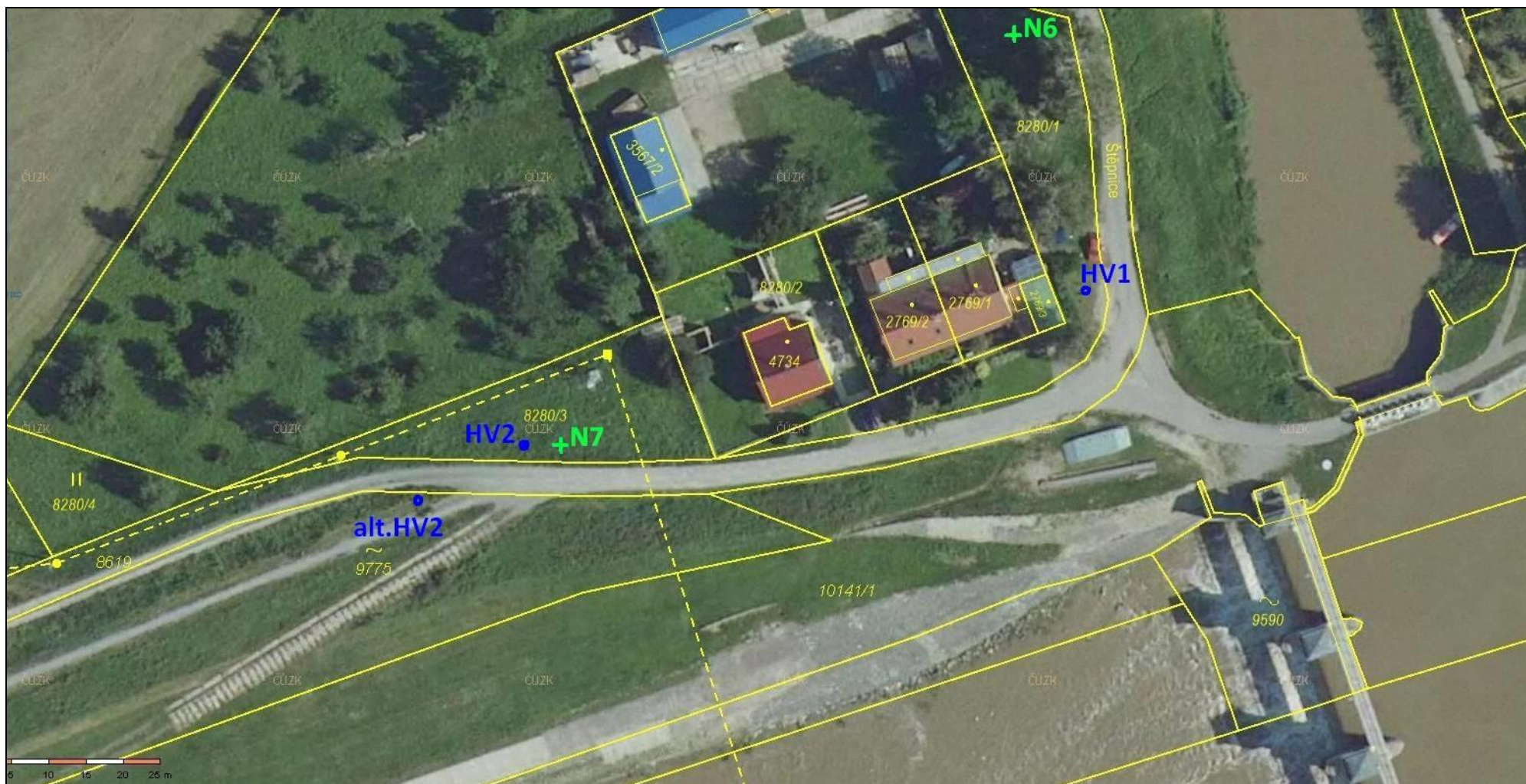
Obr. 2 - Situace umístění navrhovaných pozorovacích vrtů HV1, HV2 a stávajících vztažných bodů nivelace N6, N7 se zákresem do ortofotomapy vč. vyznačení parcel
