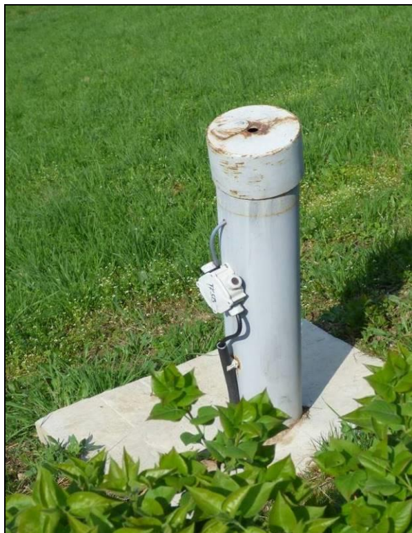
Obr. 8, 9 - Obdobný pozorovací vrt s ponořeným snímačem - sledování hladiny podzemní vody na VD Koryčany.
